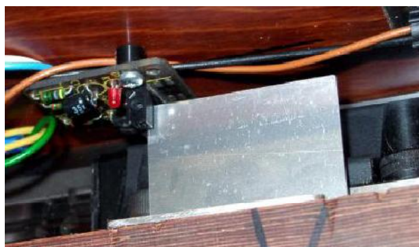
Obrázek 4.8 – Optický snímač na pracovním stole s clonou umístěnou na rámu stroje
