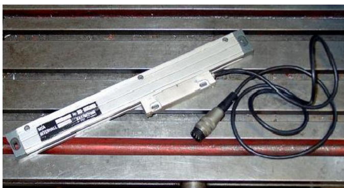
Obrázek 4.15 – Lineární enkoder připraven na montáž
