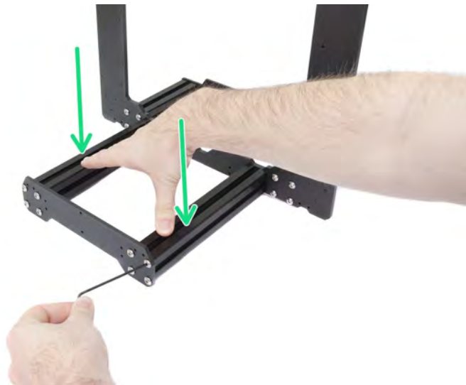
Obr. 45 - Správný způsob utažení rámu, desek a hliníkových extruzí dohromady
