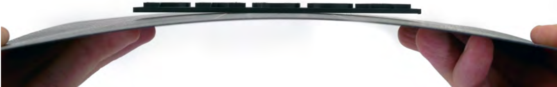
Obr. 13 - Sundání modelu z PEI povrchu prohnutím ocelového plátu. Pokud výtisk z podložky přesto nejde sundat, zkuste plát ohnout dovnitř.
