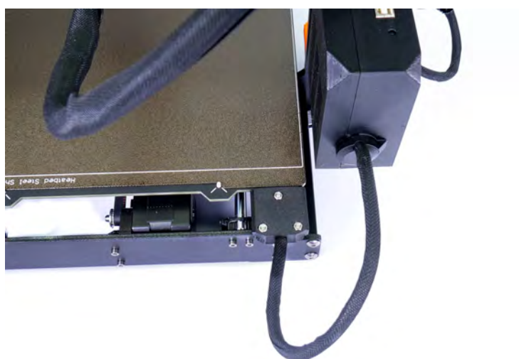
Obr. 49 - Kabely spirálovitě omotané kroucenou bužírkou
