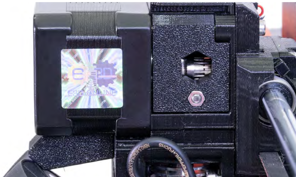
Obr. 40 - Čištění extruderu - skrz servisní otvor vidíte podávací kolečko
